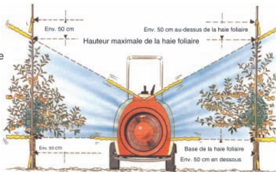
Les bandes placées environ 50 cm au-dessus et au-dessous de la haie foliaire ne doivent pas être sous l'influence du courant d'air produit par la turbine.
