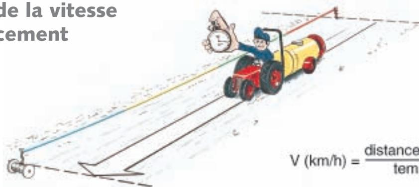
$$V \text{ (km/h)} = \frac{\text{distance parcourue (m)} \times 3,6}{\text{temps nécessaire (s)}}$$
