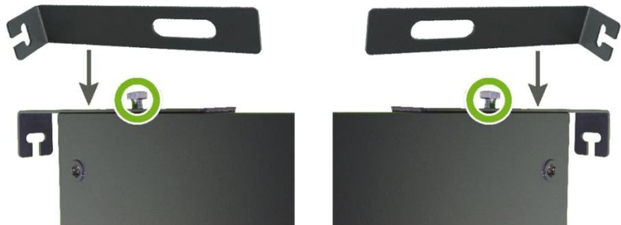
Abb. 12: Kippschutzbügel mit S10 E verschrauben
