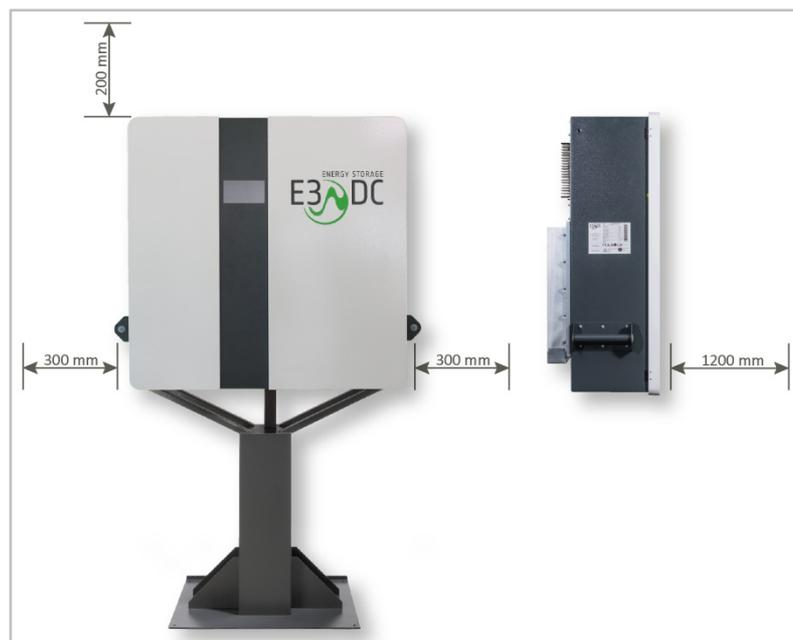
Abb. 6: Mindestabstände zu den Raumwänden, der Raumdecke und nach vorn
