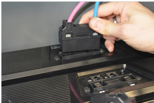
Abb. 62: Leistungskabel in Batteriemodul einstecken
