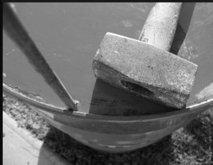
La plupart des isolants résistants au feu ne sont disponibles que sous la forme de vrac ou de feuilles fibrées. Les deux ont besoin d'être contenus, même si vous mélangez de l'argile avec de la perlite ou de la vermiculite. Soit vous créez un cylindre en treillis métallique ou en feuille de métal, soit vous utiliserez un conteneur tout fait comme un vieux réservoir de chauffe-eau dont vous aurez coupé les extrémités. Les matériaux usagés sont tout à fait adaptés. On peut les obtenir chez le
