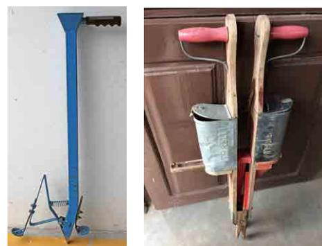
**Figure 12.** Canne planteuse utilisée dans la ferme d'expérimentation de ECHO en Floride (à gauche) et une canne planteuse utilisée en Afrique de l'Est (à droite). Source: Tim Motis (à gauche) et Stacy Reader (à droite)
