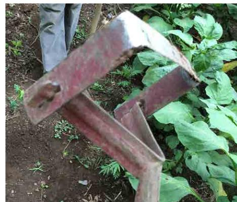
**Figure 11.** Un type de binette appelé «houe à étrier» ou «houe de poussée et de traction», celui-ci fabriqué en Tanzanie. *Source: Stacy Reader*
