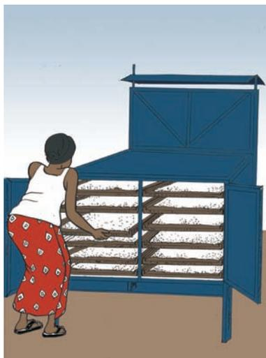
Fig. 10 C : Séchage en cabine
