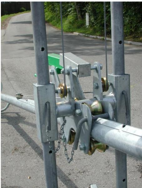
Graisser les rouleaux du dispositif de porte de la barre agitatrice, le tube de guidage, les roulements des roues ainsi que les vérins des béquilles d'une graisse visqueuse de bonne adhérence.
