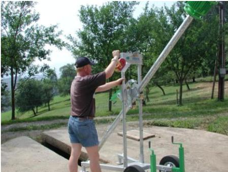
S'il s'agit d'une fosse avec une petite trappe d'abord hausser le dispositif de porte de la barre agitatrice au moyen du treuil et la fixer dans le cran le plus haut au tube de guidage. Ensuite fortement incliner la barre agitatrice au moyen du vérin à vis.
