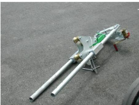
Fixer à vis le tube de guidage avec le dispositif de porte de la barre agitatrice et le treuil sur le bâti à deux roues.
