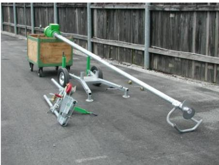
A cet effet placer la barre agitatrice sur le bâti à deux roues en supportant le moteur.
