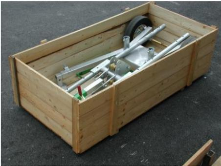
Pour faciliter le transport le bâti à deux roues, le tube de guidage vertical avec le dispositif de porte de la barre agitatrice et le treuil ainsi que la barre agitatrice complète avec le moteur, le réducteur à roue droite, l'hélice et le cintre protecteur sont fournis en état non assemblés. Ainsi faut-il assembler les différents composants avant la première mise en service.
