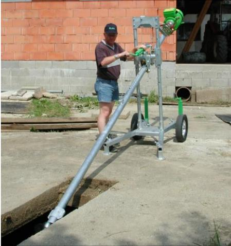
La mise en place de la barre agitatrice dans la trappe de fosse (60 x 60 cm au minimum) se fait sans effort à l'aide du treuil – relevage et descente – et du vérin de réglage – orientation.
