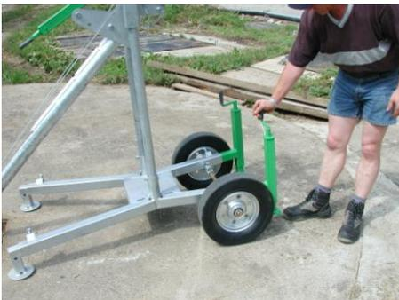
Sortir les deux vérins béquilles au moyen des manivelles jusqu'à ce que les roues soient assurément décollées du sol. S'il s'agit d'un plancher en béton on conseille d'y faire des entailles pour mieux retenir les vérins béquilles. Ces béquilles, en commun avec les appuis avant, absorbent les efforts de poussée produits pendant la marche du mixer.
