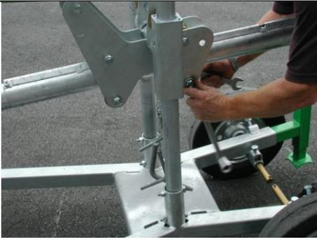
Enlever les deux rouleaux inférieurs avec les douilles d'écartement du dispositif de porte de la barre agitatrice.....
