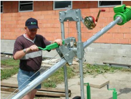
Simultanément détendre le câble au moyen du treuil
