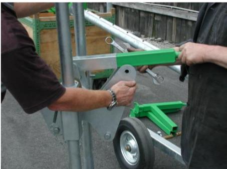
Fixer le vérin de réglage avec le boulon de retenue sur le dispositif de porte de la barre agitatrice.
