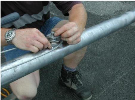
Mettre la boucle de câble autour de la poulie de renvoi en partant du dispositif de porte de la barre agitatrice...
