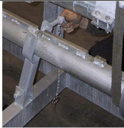
Placer la pompe dans le dispositif porteur du bâti de relevage, le tube d'entraînement se trouvant en bas.
