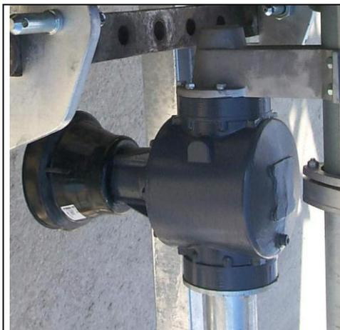
L'engrenage est rempli de 2 litres d'huile de moteur de qualité Spirax 90 EP jusqu'au niveau de la vis de contrôle. Premier changement d'huile après 50 heures de service, ensuite toutes les 800 à 1000 heures.
