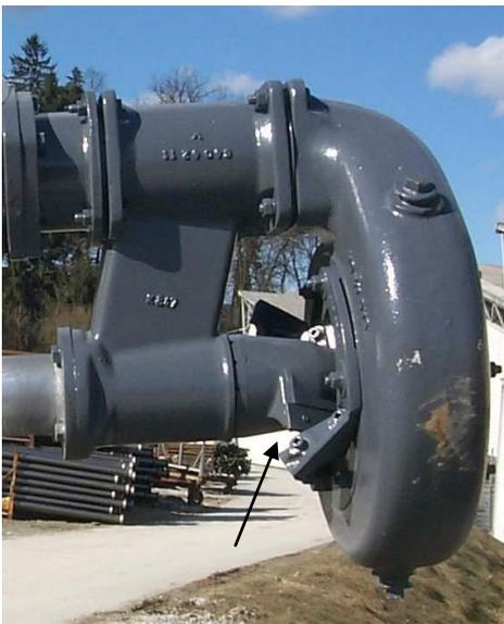
Contrôler les tranchants des lames. Leur construction spéciale permet de les utiliser à 4 tours avant qu'il devienne nécessaire de les réaffûter.
