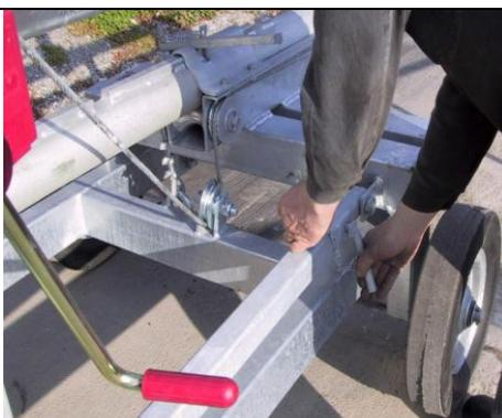
Oter les boulons de retenue de la fourche de support et du dispositif d'orientation.
