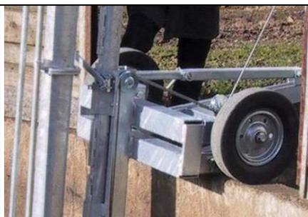
Après avoir dressé la pompe en position verticale remettre en place le boulon de retenue du dispositif d'orientation afin de l'arrêter.
