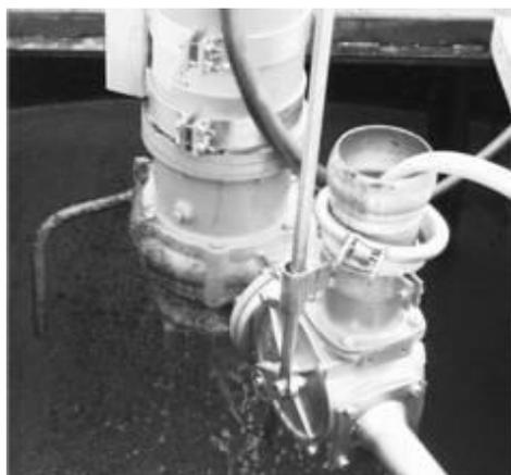
Le nettoyage intérieur des tubes et de la robinetterie se fait de préférence – et s'il y en a la possibilité - par le pompage de l'eau pur pour un certain temps.
