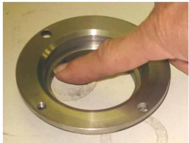
1. Mesurer l'écart « A » entre niveau anneau support 343 0202 et niveau bride d'engrenage
