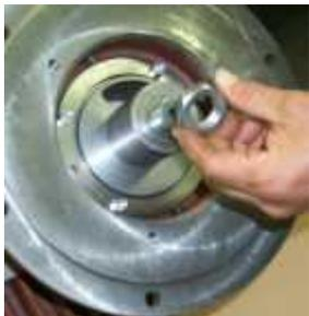
Monter l'écrou pour fixer la douille d'écartement - longueur de montage 45+/-0,5mm
