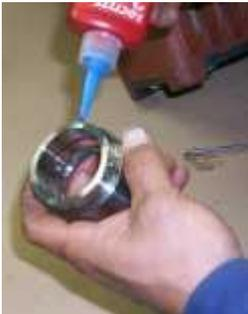
Appliquer de la Loctite sur le filetage.
