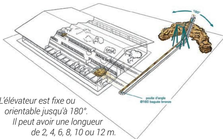
L'élévateur est fixe ou orientable jusqu'à 180°.
