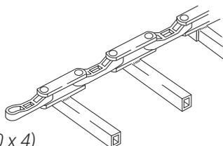
La chaîne d'entraînement (60 x 40 x 4) circule dans la rigole de récupération de 2 x 40 cm de largeur et de 30 cm de profondeur minimum avec possibilité d'agrandissement à 45 ou 50 cm. Des châssis de 45° ou de 90° permettent de gérer les courbes de la chaîne.
