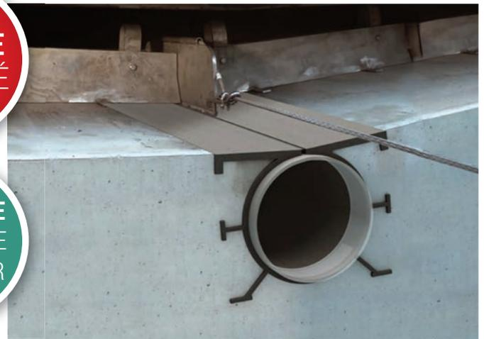
Livré en section de 4 mètres, ce caniveau profilé s'installe sur des plots ou la semelle de la salle, avant le coulage du béton, ce qui réduit considérablement les investissements pour la construction.
