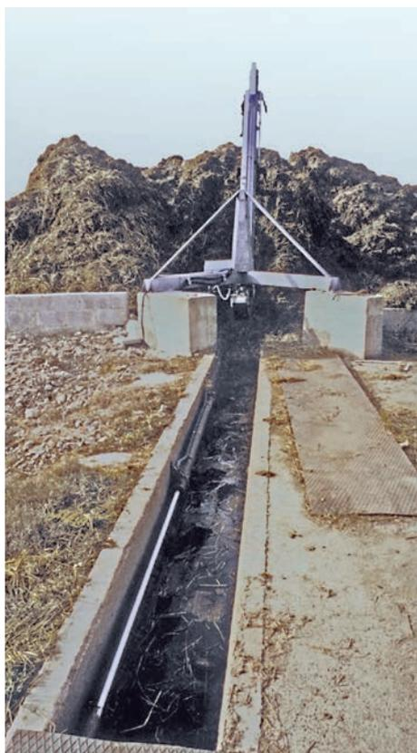
*Reprise hydraulique va et vient*
