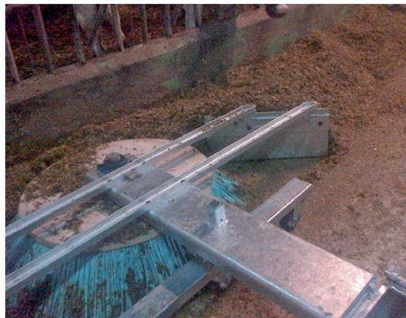
*Des brosses aux fibres résistant à l'acidité de l'ensilage sont fixées sur les bras du racleur, entraînées par la force centrifuge.*
