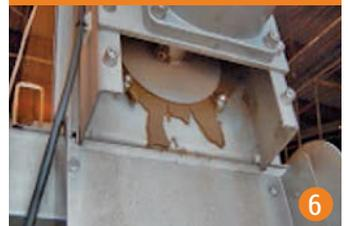
La plaque d'extrémité comprime ensuite les effluents pour faciliter la déshydratation. 25% de Matière sèche.
