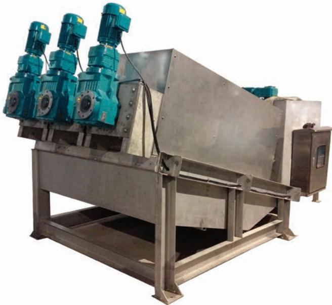
Les effluents sont d'abord acheminés dans le réservoir de mesure puis descendent vers le bassin de floculation, où le polymère est ajouté.
