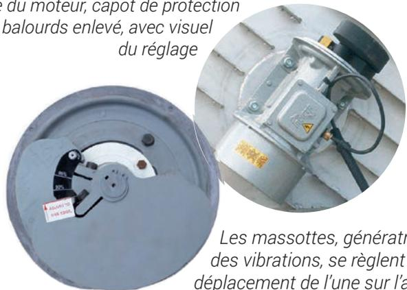
Les massottes, génératrices des vibrations, se règlent par déplacement de l'une sur l'autre selon la densité du produit à tamiser
