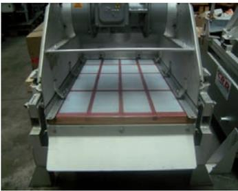
Séchage et taux de séparation varient selon le type de produit à traiter, l'inclinaison du tamis, la vitesse de défilement, la fréquence des vibrations.
