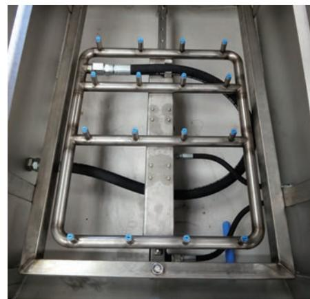
Lavage automatique, fréquence et débit réglables, permet l'augmentation du débit du tamisage.
