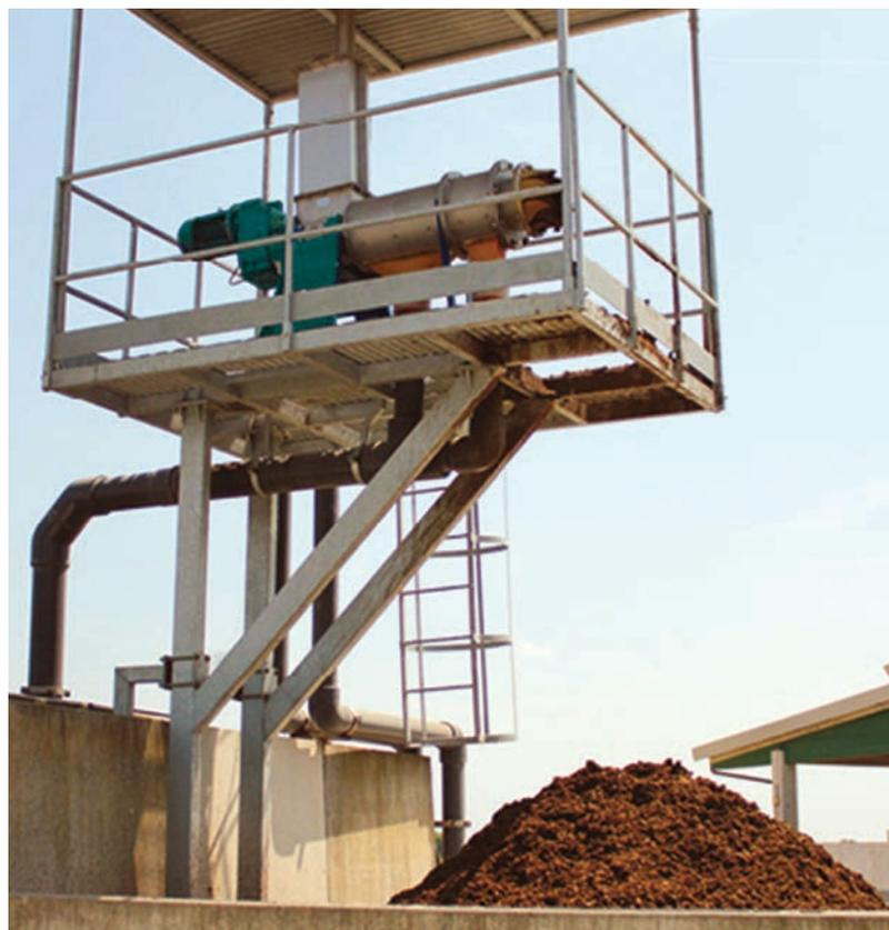
Le Séparateur à vis CRD se compose d'un corps d'alimentation équipé d'un réservoir compensateur et une trémie de trop-plein.
