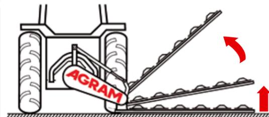
2 - à la fin du chantier, le chauffeur commande le vérin au maximum et la faucheuse se place en position transport sans que le patin ne touche le sol et se verrouille automatiquement.
