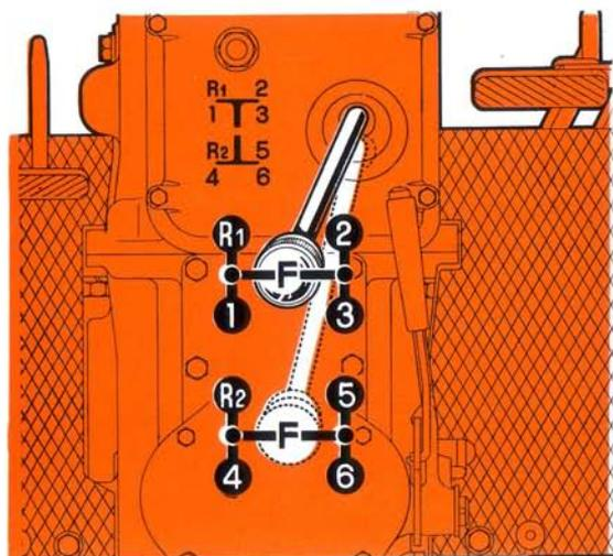
**FIG. 7. — Positions du levier de changement de vitesses.**
