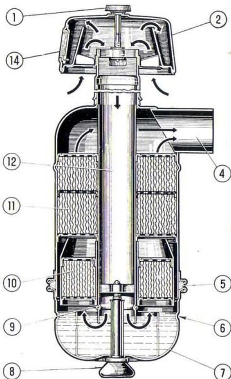
la vis inférieure et vérifier si l'huile arrive à la rainure circulaire. Le niveau d'huile devra être vérifié une demi-heure au moins après l'arrêt du moteur de sorte que l'huile en suspension dans les masses filtrantes, ait le temps de descendre dans la cuve.
