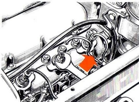
Pour déposer les injecteurs, ôter les tuyauteries et leur écrou de fixation (fig. 27). Pour les remonter, se servir d'une clé dynamométrique (couple de serrage **6 m.kg.**)
