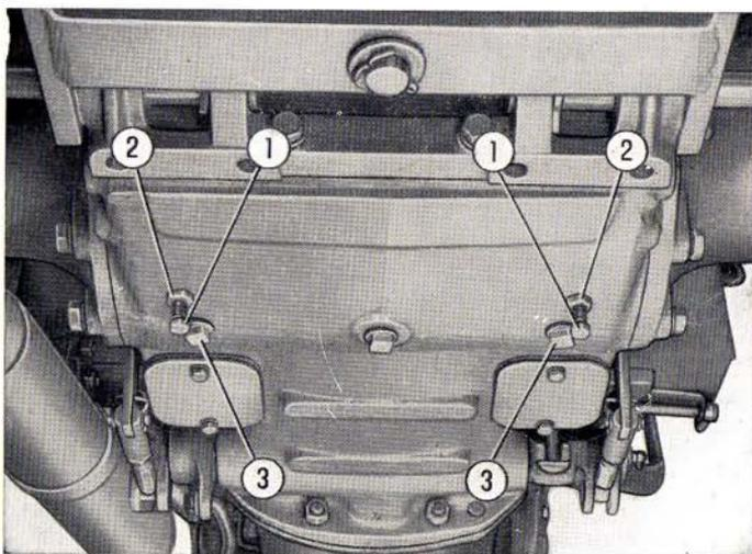
**FIG. 26 — Vis de centrage des rubans de freins**
