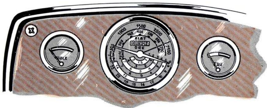
**FIG. 13 — Horotachymètre.**
