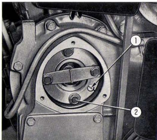
**FIG. 34. — Toc d'entraînement de la pompe d'injection.**
