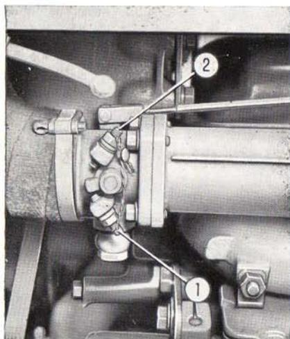
FIG. 30 — Vis de réglage du régime moteur.
