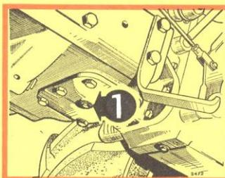
**38** **CARTER INTERMEDIAIRE** - Vidanger par le bouchon 1. Effectuer le remplissage par le bouchon 1 FIG. 14.
