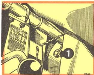
**33** **BOITIER DE DIRECTION** - Vidanger au moyen d'une seringue par le bouchon 1. Effectuer le remplissage par le même bouchon.
