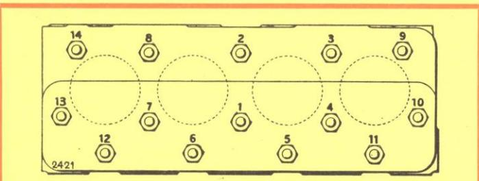
**18** **CULASSE ET CULBUTEURS** - Après la période de rodage, vérifier, le moteur étant FROID le serrage de la culasse (22 à 23 m. kg).
