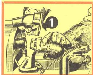
**34** **THERMOSTAT** - Contrôlez son comportement thermique et vérifiez si le trou de sécurité n'est pas obstrué. Examinez attentivement l'état du joint torique contenu dans le boîtier 1.
