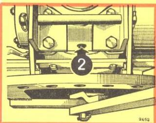
**41** **BLOC POULIE PRISE DE FORCE** - Vidanger par le bouchon 2. Effectuer le remplissage par le bouchon 1 de la fig. 17.
