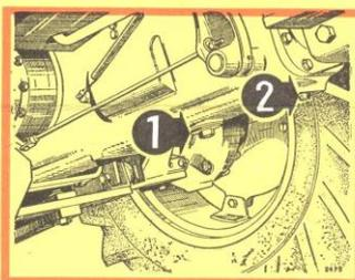
**39** **BOITE DE VITESSES** - Vidanger par les bouchons 1 et 2. Effectuer le remplissage par le bouchon 2 FIG. 15.
