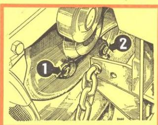
**40** **RÉDUCTEURS DE ROUES** - Vidanger par le bouchon 2. Effectuer le remplissage par le bouchon 1.
