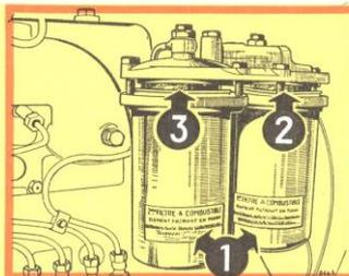
**37** **FILTRE A COMBUSTIBLE** - Démontez les cuves 1, extrayez les cartouches 2 et 3 et nettoyez les cuves 1 à l'essence ou au pétrole. Remettez en place des cartouches NEUVES, puis remonter l'ensemble.
