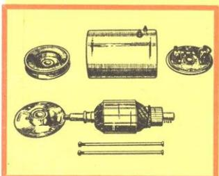
**36** **DYNAMO** - Procéder au nettoyage général, puis vérifier les balais et graisser légèrement les pallers de l'induit.
