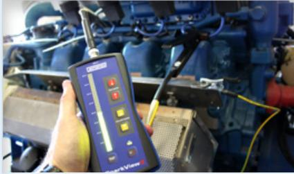
Le terminal mobile nouvellement conçu sert à contrôler le besoin en haute tension de la bougie d'allumage pendant le fonctionnement. En utilisant une pince ou un câble de mesure inductive et grâce à l'affichage jusqu'à 40 kV, il est possible de se renseigner facilement sur l'état des bougies d'allumage et de déterminer le moment idéal pour les remplacer.
