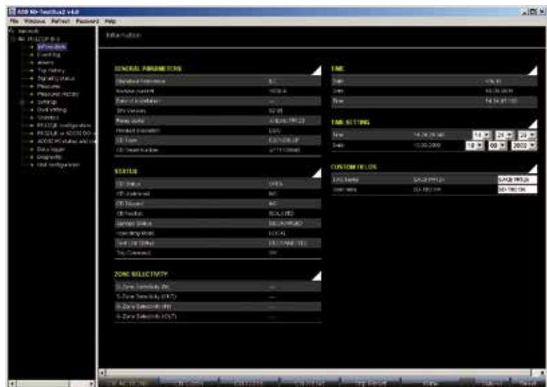
L'Ekip Connect effectue un balayage automatique du bus RS-485, relève tous les dispositifs reliés et vérifie leur configuration, en contrôlant toutes les combinaisons d'adresses possibles, parités et vitesses de transmission (baud rate). Un simple click sur SCAN permet de mettre en évidence:
