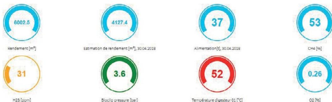
Système d'alertes avec des feux verts, jaunes et rouges pour les alertes avec des seuils d'alarme programmée
