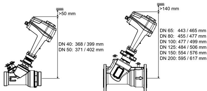
\*) Hauteur en fonction de la version du servomoteur.
