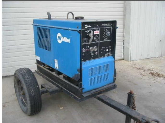
La plupart des appareils de soudage modernes disposent d'un volant pour le réglage en continu de l'intensité.
