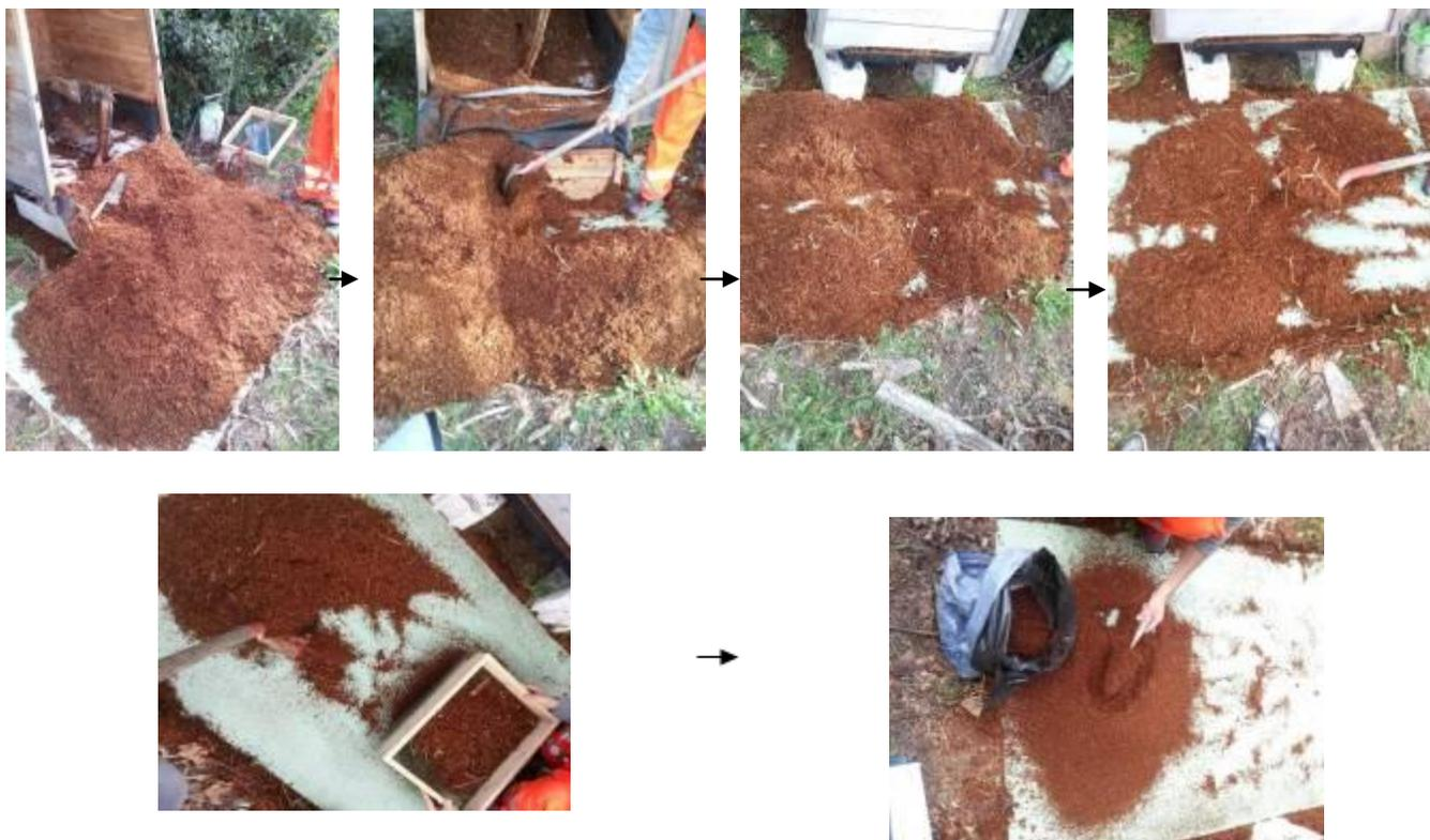
Photo 9 : Prélèvement d'échantillons par la méthode des quartas, sur le site de Gigondas
