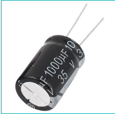
Comme vous le constatez, le redresseur ne délivre pas de courant continu. Le condensateur permet de stabiliser au mieux le courant qu'il reçoit et ainsi s'approcher au mieux du courant que l'on recherche.
