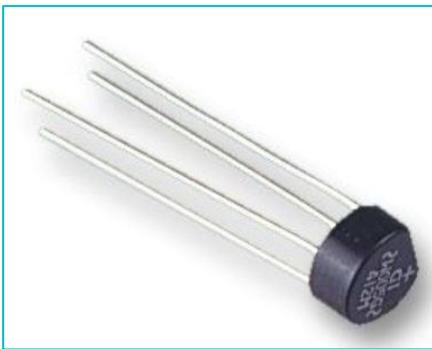
Le redresseur est le premier composant du circuit. Son rôle est de redresser le courant créé par le moteur, on parle de courant alternatif redressé.
