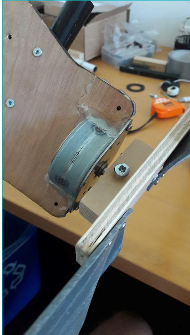
4. Si le moteur n'est pas encore installé sur l'aileron, installez-le dans l'emplacement prévu à cet effet, puis fixez-le à l'aide de colle ou de vis si besoin, assurez-vous que le moteur est bien encastré et ne bouge pas.
