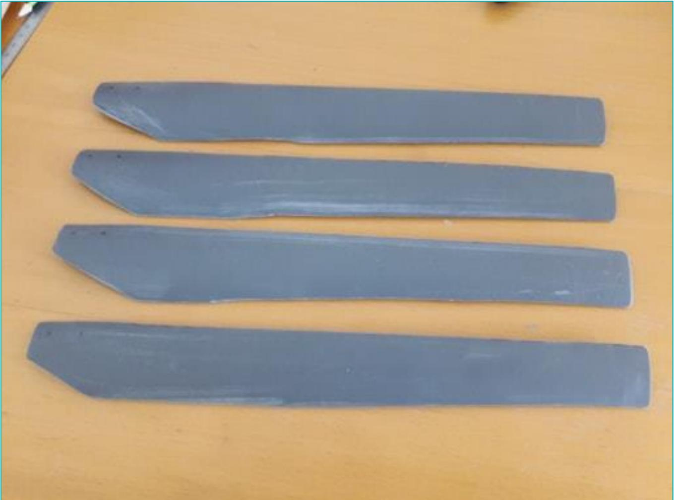
**IMPORTANT** : Une fois les pales installées, elles ne doivent pas être trop vrillées au risque de se briser par vent fort. Le bout des pales doit être quasiment plat.
