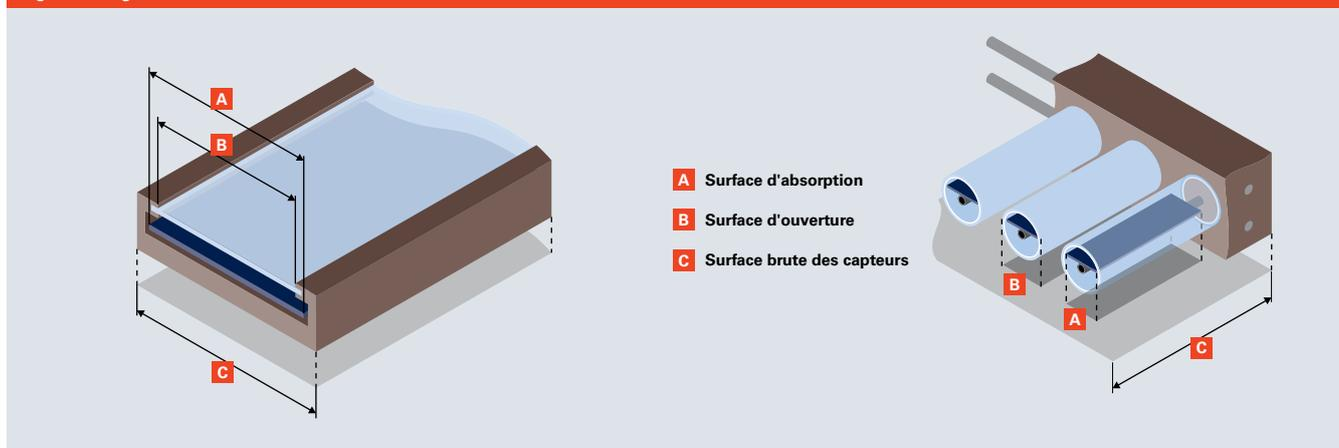
La surface de mesure utilisée est déterminante pour calculer la taille d'un capteur.
