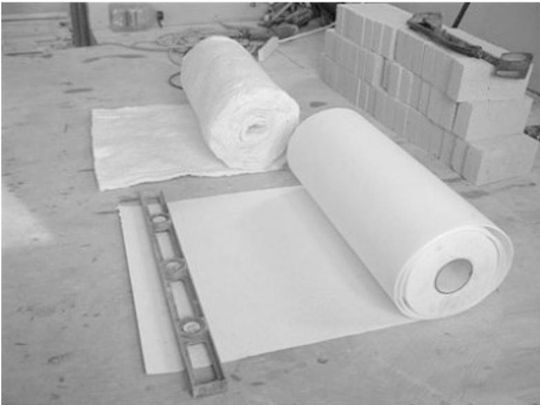
Laine de céramique RT6 et papier en céramique de 1/8 de pouce (dans le premier plan). Les laines est employée pour le joint de dilatation entre le noyau et les murs latéraux du canal et est utile comme garniture pour l'étanchéité des fumée autour des raccordements de cheminée. Le papier est employé entre chacun des modules réfractaires qui forment le four. Il assure l'étanchéité pour la fumée et joint de dilatation. Tous les modules de fours peuvent se dilater
