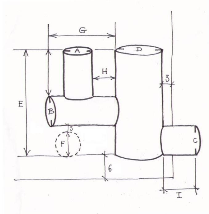
Prévoir 2 cm de marge en hauteur afin de conserver une prise pour le retrait des coffrage (pièces A et D du brûleur, et Q du collecteur)
