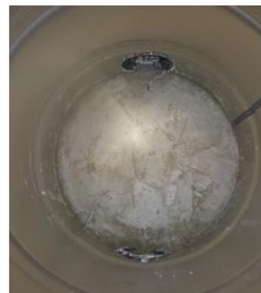
Compacte bien le mélange au moyen d'un tasseau lors de la mise en œuvre. Attention à bien faire ressortir les fils de maintien du moulage !
