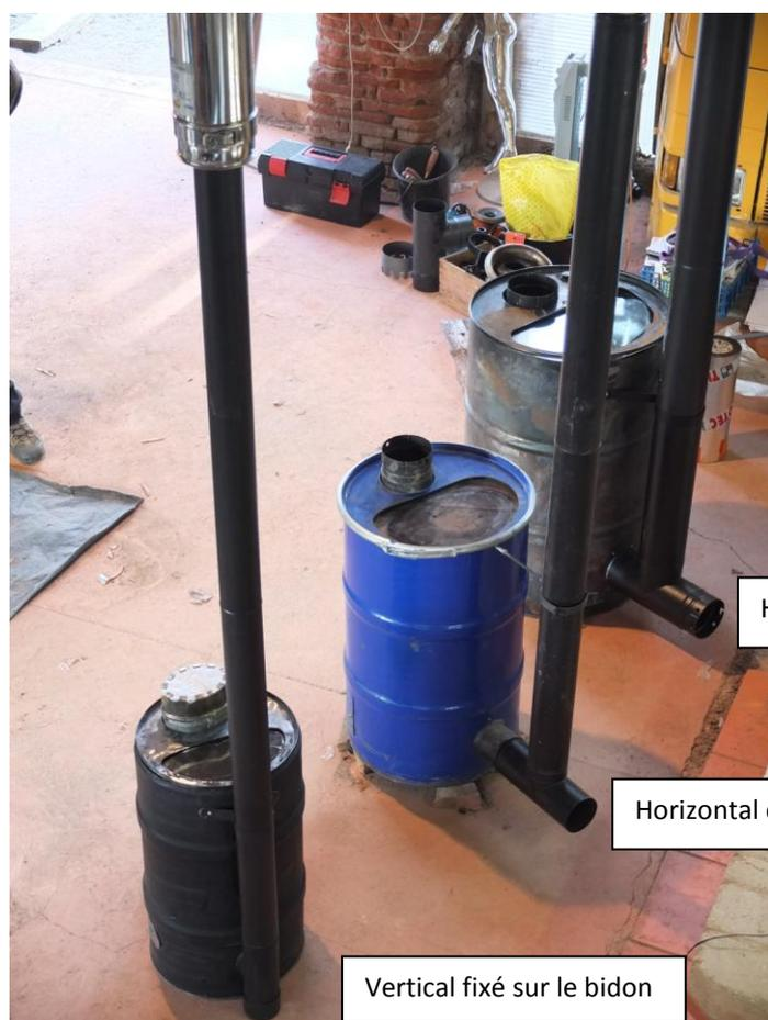
Il est préférable de ne pas fixer le T directement sur le bidon : c'est très encombrant lorsqu'on veut déplacer le poêlito. Sur un Pito60 néanmoins c'est tolérable ...
