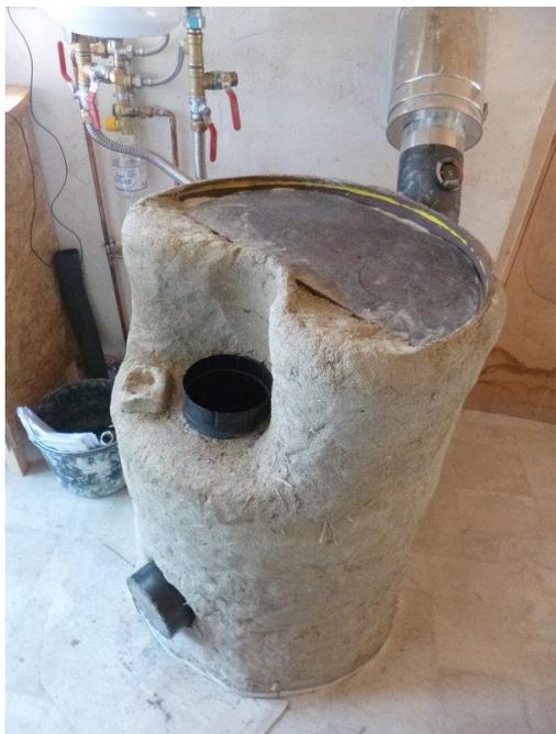
**Une alternative :** comme sur les poêles rocket d'origine tu peux faire un conduit d'alimentation moitié plus bas que le conduit de remontée des flammes. Ainsi le tirage est plus aisé à établir à l'allumage. Pour cela il faut découper le bidon et le repousser vers l'intérieur. Cela implique de refaire une étanchéité pour le sable. C'est plus adapté à un poêle enduit, à moins de maîtriser le travail du métal...
