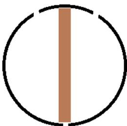
Le morceau du dessus constitue une "clé" facilement amovible. Une cale en bois permet de la maintenir en place pendant le coulage. Au décoffrage on retire la cale, puis la clé. Il est ensuite aisé de retirer les 2 morceaux restant par les trappes de ramonage, et enfin le plastique d'emballage.
