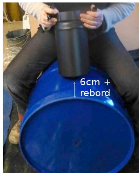
Les deux tubes doivent être à 6 cm du fond du bidon. C'est l'épaisseur de la couche de matière qu'on va placer au fond. Fais attention au rebord extérieur pour prendre ta côte (c'est 6 cm depuis le fond, auxquels il faut ajouter l'épaisseur du rebord, soit environ 1,5 cm).
