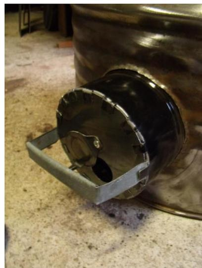
Le système de réglage de l'air primaire (au cendrier) doit être précis et efficace. Il permet de contrôler la puissance de combustion.
