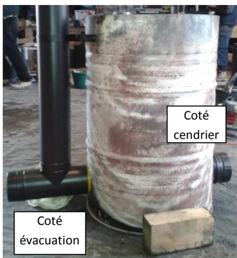
Le bidon doit être percé de 2 trous diamétralement opposés permettant d'introduire des tuyaux. À l'avant le tube de diamètre 100/130/150 mm servira d'entrée d'air et d'évacuation des cendres. À l'arrière le tube de 80/100/130 mm servira à connecter le tuyau d'évacuation des fumées (respectivement les diamètres du modèle Pito 60/120/200).
