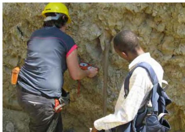
Mesure d'un affleurement à Port-de-Paix pour l'extension du microzonage sismique d'Haïti (Port-au-Prince, Haïti).
