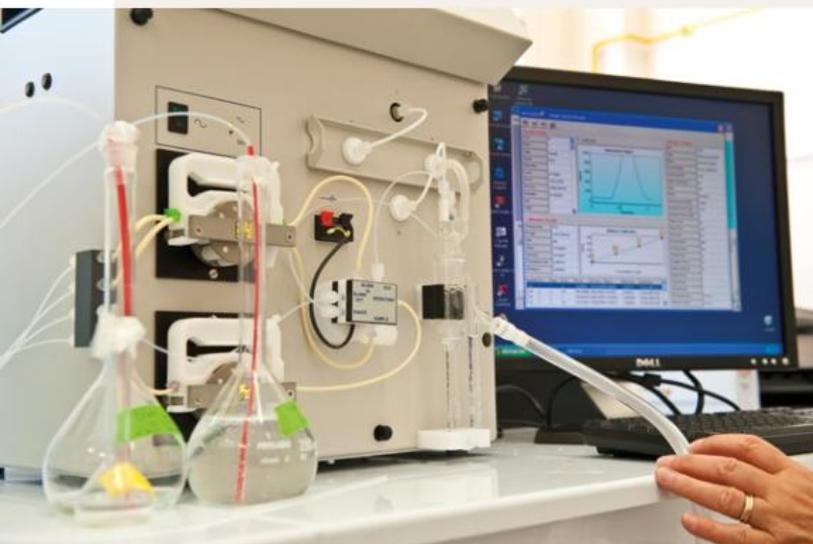
Détermination du sélénium et de l'arsenic par couplage chromatographique liquide/fluorescence atomique.
