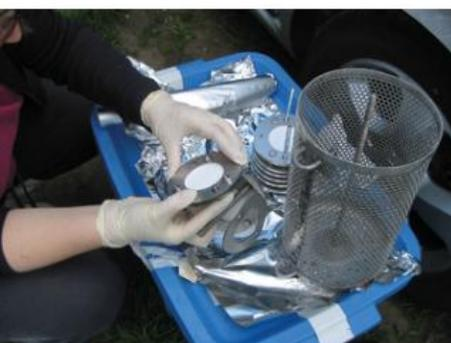
Systèmes de déploiement pour les échantillonneurs passifs pour polluants apolaires.
