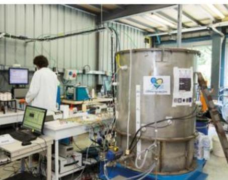
métrique doit permettre à tout type d'utilisateur (BRGM, établissements de recherche, entreprises privées) de réaliser des expérimentations dans des conditions très proches de l'in situ mais bien mieux contrôlées. D'un volume utile de 120 m<sup>3</sup> environ, il permet notamment d'analyser à grande échelle et en trois dimensions les processus réactionnels présents dans les zones non-saturée ou saturée en eau.
