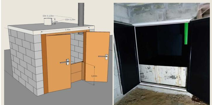
Plans et photos d'un composteur relié à une toilette avec un accès par une menuiserie étanche à double vantaux avec batardeau (amovible)
