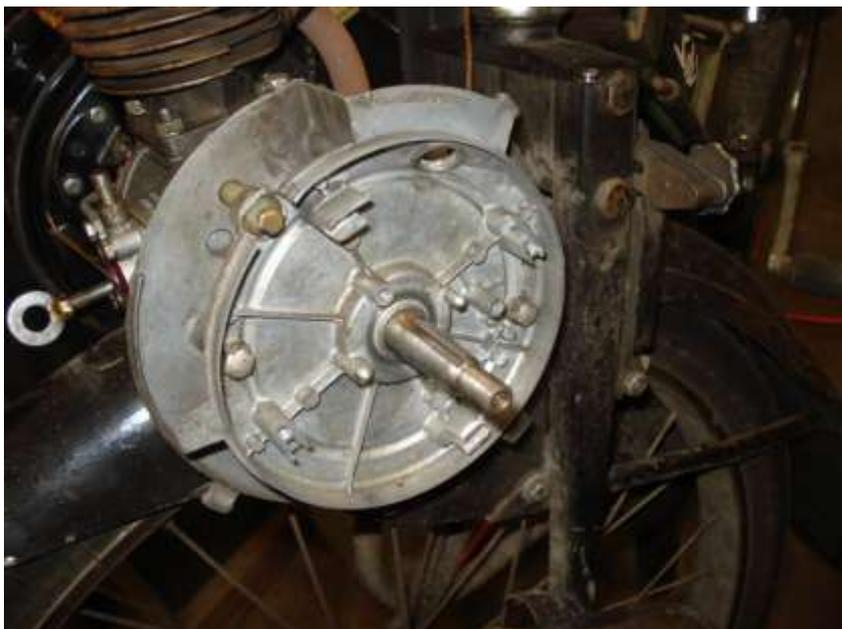
Il faut maintenant monter la plaquette en plastique à la place 2 vis de droite du support des vis platinées
