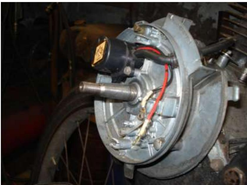
Ensuite monter la bobine d'allumage, mais celle-ci se monte en bas, a la place de l'éclairage et relier le fil noir a la masse (une des vis de la plaquette en plastique suffit).
