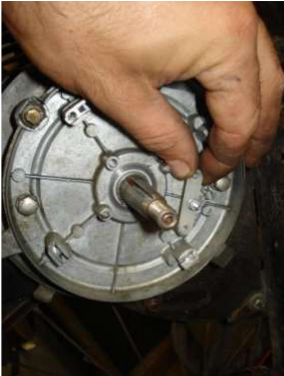
Monter le boîtier CDI a la place de la vis de gauche du support des vis platinées, et relier le fil noir a la masse (une des vis de la plaquette en plastique suffit).
