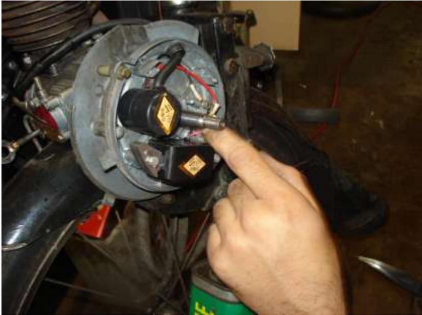
Brancher les 2 fils rouge ensemble sur la vis au milieu de la plaquette en plastique.
