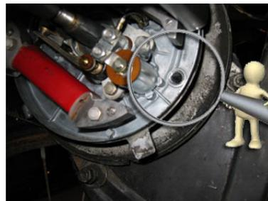
Puis, on met en place l'arrache moyeux en prenant appui sur la partie inférieure des pieds de bobine.
