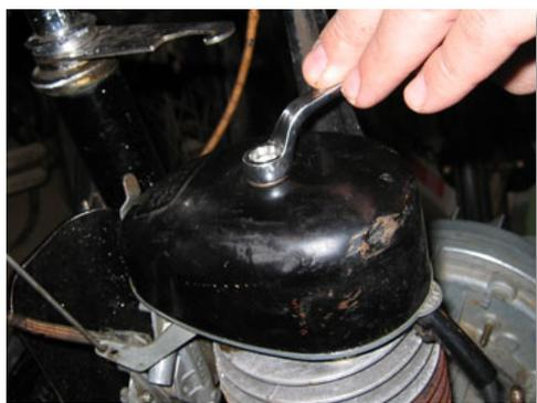
on dépose le filtre à air,
