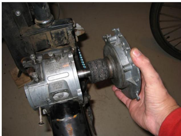
Bien dégraisser la cloche d'embrayage (dégraissant pour freins par exemple). D'une cloche grasse résultera un embrayage qui patine, voir un moteur qui tourne mais qui n'avance pas!
