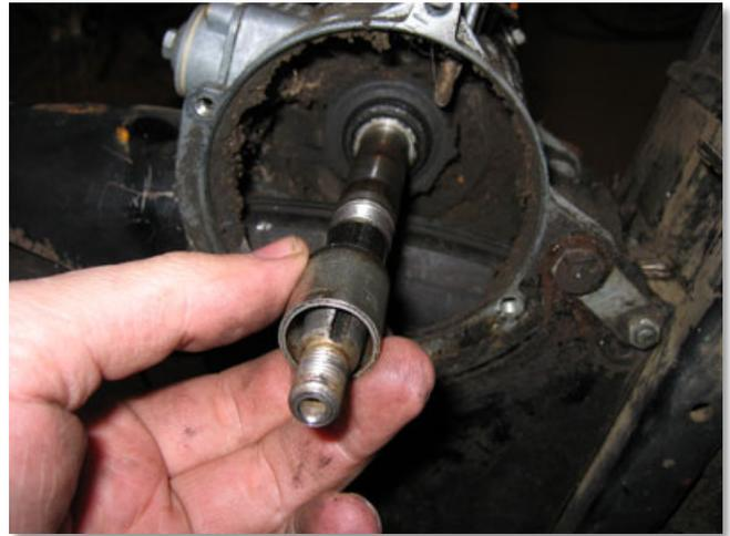
**ATTENTION :** autant que faire se peut, ne démontez pas la tripaille de roulements, bagues et autres entretoises des galets issus des modèles 1700 et 2200... car il est fort probable que vous n'aurez pas l'outillage nécessaire pour tout remettre correctement en place (presse hydraulique, cotes de positionnement précises...)... d'autant que ces roulements sont très rarement à changer ! En effet, ils ne fonctionnent que lorsque le moteur tourne avec l'embrayage déclenché (feux rouge, stop...).
