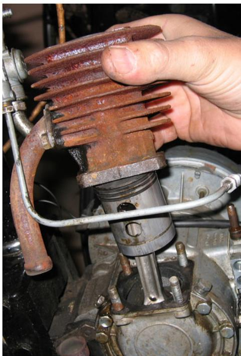
Le plus dur est fait; reste à remettre en place le bloc supérieur du moteur, en prenant soin dégraisser un peu de cylindre avec de l'huile 2T avant d'y insérer le piston.
