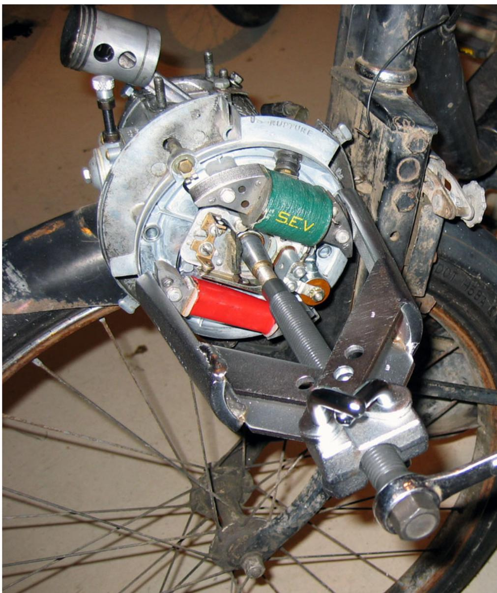
**ATTENTION:** l'outil d'origine Solex prenait appui sur les 4 pieds. Dans notre cas, nous ne prenons appui que sur 2 pieds... ce qui veut dire que l'effort d'extraction sera double au point d'application. Il faudra donc y aller doucement pour ne pas risquer de détériorer ou fausser la platine du stator. Rassurez-vous, je démonte toujours de cette façon... et à ce jour sans aucun problème rencontré!
