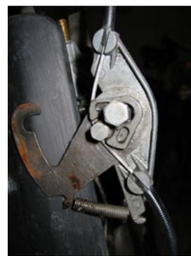
on retire le mécanisme de synchronisation du carburateur.
