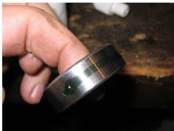
**ATTENTION:** cette opération est délicate: il faut garder le roulement au maximum parallèle avec le carter et éviter ainsi de fendre le bloc moteur. **Il est impératif de pousser exclusivement sur la bague extérieure du roulement** (cale comme une douille de 32 ci-dessous, marteau, presse, belle-mère...), car à défaut, c'est le matage assuré de la portée des billes et donc un roulement potentiellement HS avant même d'avoir servi !)
