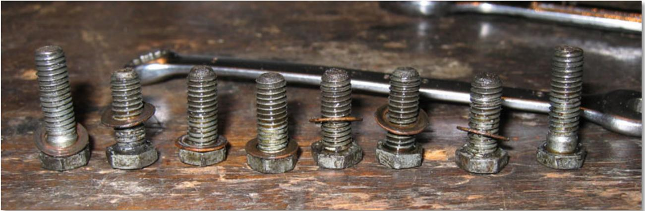
Notez au passage que deux des écrous sont plus longs; ils proviennent des deux trous supérieurs. On se rappellera de cela au remontage!
