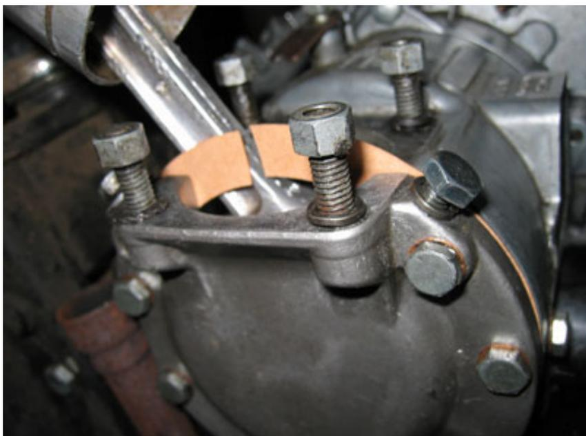
Au passage, vous pouvez avantageusement remplacer le joint par de la pâte à joint résistante aux hydrocarbures ;-)
