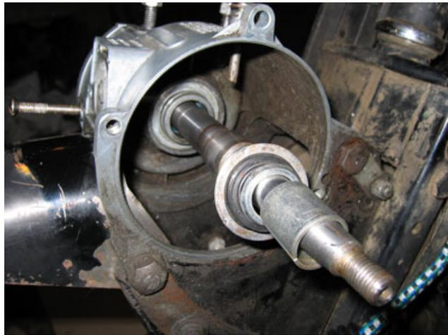
Bien plaquer le vilebrequin contre le 6203, rondelle entre les deux bien en place sur l'épaulement. Un vilebrequin mal positionné viendra cogner sur le carter du moteur une fois en fonctionnement.
