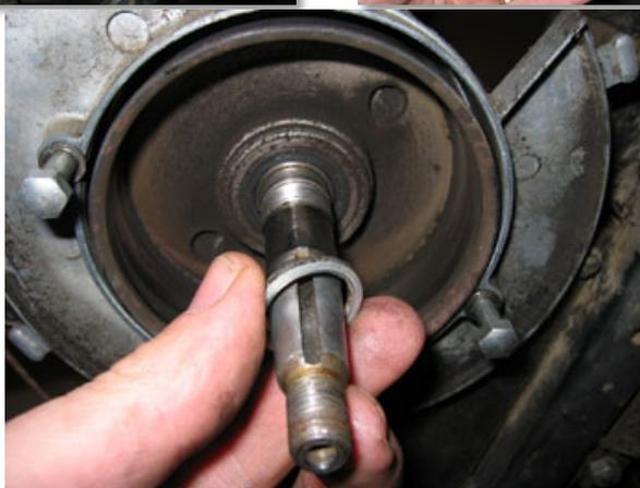
Notre embrayage est sorti, reste à extraire le bloc galet (qui comprend également la cloche d'embrayage dans notre exemple). Plusieurs cas de figure se présentent, fonction des modèles :
