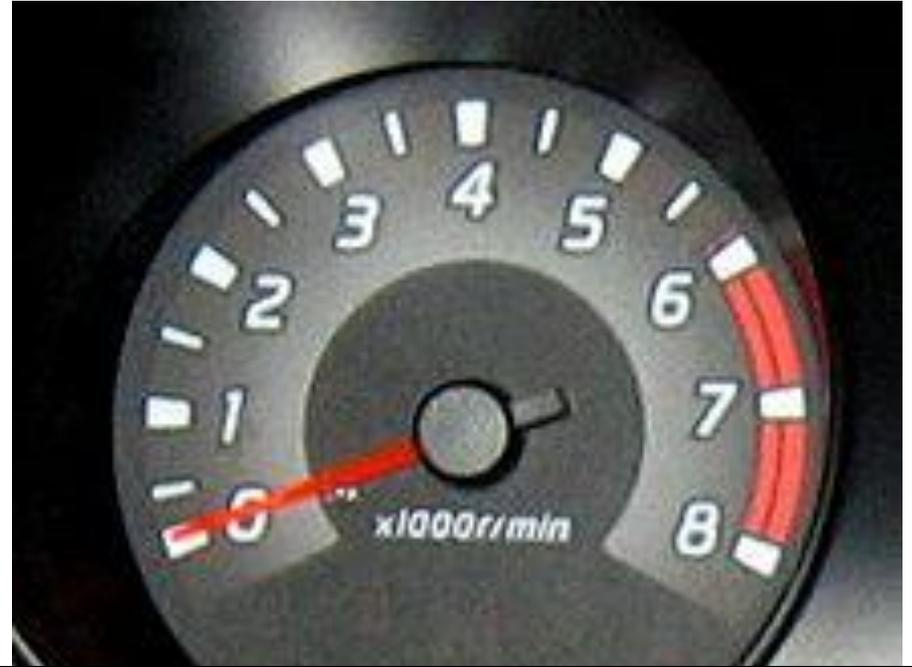
**NOTE** : quand l'aiguille est dans la **zone rouge** cela signifie que le moteur est dans des conditions de mauvais rendement énergétique (donc la consommation s'en ressentira ...) La limite maximale est variable selon la catégorie du véhicule et le type de moteur (essence ou diesel).
