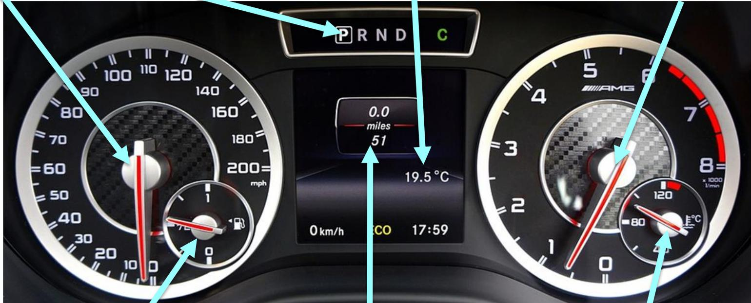
Indicateur de niveau de carburant dans le réservoir
