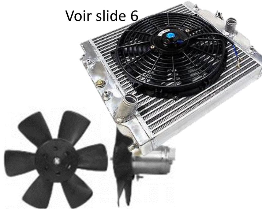
Le ventilateur sert à forcer la circulation de l'air dans le radiateur. Ceci est particulièrement important lorsque le véhicule est à l'arrêt avec le moteur qui tourne.
