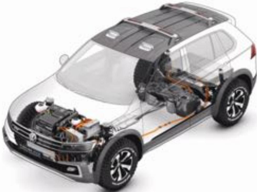
Dans cette configuration, le châssis est fusionné avec la carrosserie.
