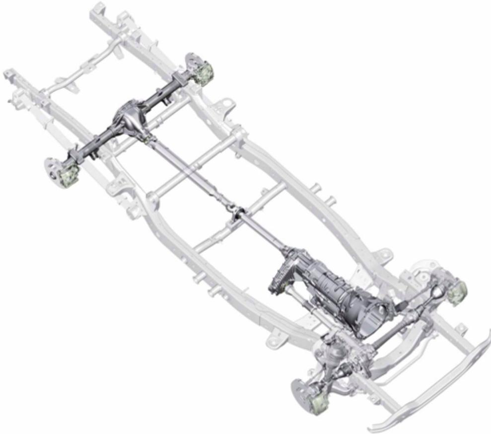
C'est un châssis composé de deux bras solidarisés sur lequel tous les éléments du véhicule viennent se monter:
