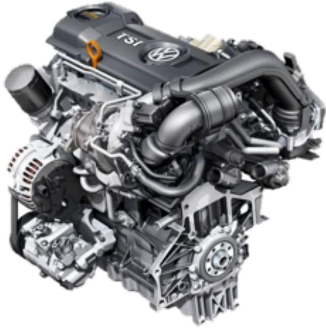
Il est le « cœur » du véhicule. Il lui permet d'avancer en transformant une forme d'énergie (carburant, électricité, air comprimé, etc.) en énergie mécanique (mouvement). Actuellement, 100% des véhicules que nous commercialisons fonctionnent avec un moteur thermique (essence ou gazole).
