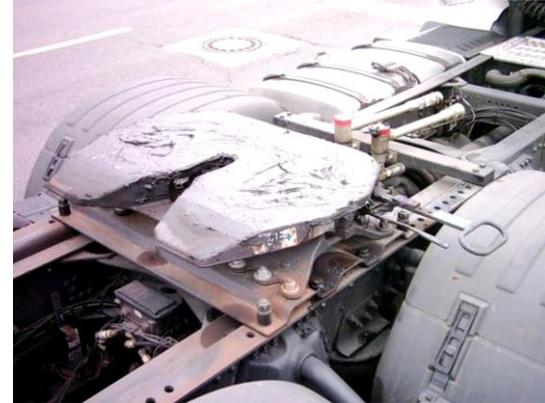
C'est le nom donné à la plateforme sur laquelle vient reposer l'avant d'une semi-remorque accrochée à un tracteur routier.
