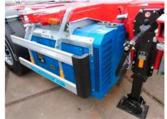
l'atelage est aussi alimenté en électricité pour les besoins d'éclairage et de signalisation. Selon le type, les besoins peuvent varier.
