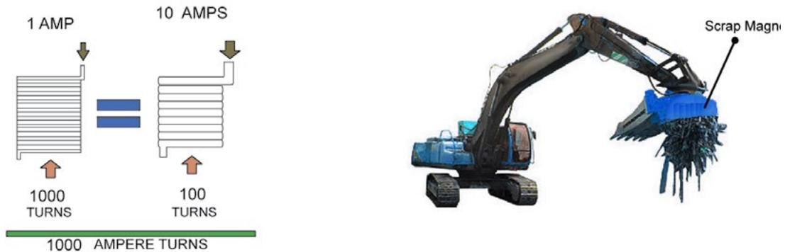
Un électroaimant avec un courant d'un ampère circulant dans 1 000 tours de câble et un autre électroaimant avec un courant de 10 ampères circulant dans 100 tours de câble généreront chacun 1 000 tours/ampère, qui est une mesure de la puissance du champ magnétique.
