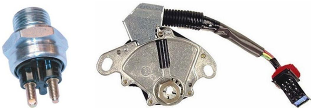
Un contacteur de sécurité de démarrage défaillant ou mal ajusté peut empêcher le moteur de démarrer. Si le véhicule ne démarre pas, il convient de vérifier l'intégrité du contacteur de sécurité de démarrage en déplaçant le levier de vitesses dans diverses positions tout en essayant de démarrer le véhicule. Si le démarreur commence à fonctionner, vous devez réajuster le contacteur.
