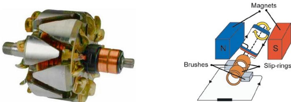
Une source d'électricité extérieure est nécessaire pour exciter le champ magnétique de l'alternateur.
