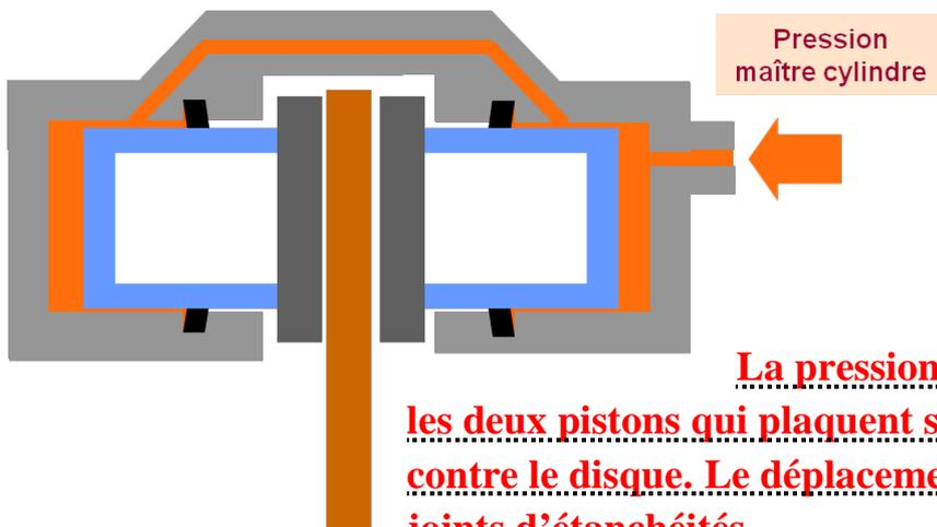
La pression du maître cylindre agit sur les deux pistons qui plaquent simultanément les plaquettes contre le disque. Le déplacement des pistons déforme les joints d'étanchéités.
