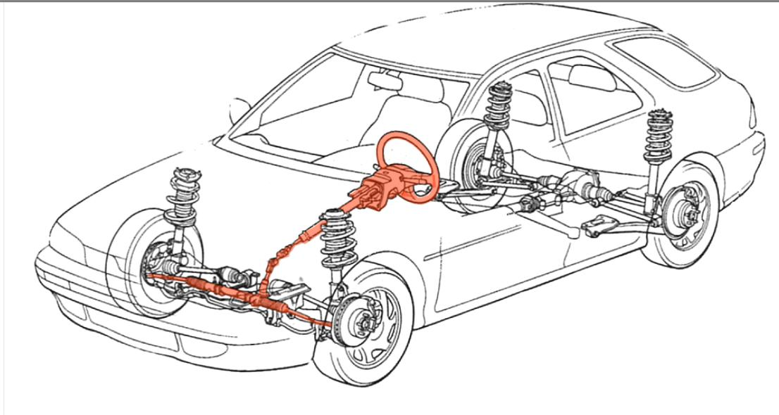
**Ensemble de pièces mécaniques permettant de modifier la trajectoire d'un véhicule en fonction du tracé de la route, des manœuvres à effectuer.**
