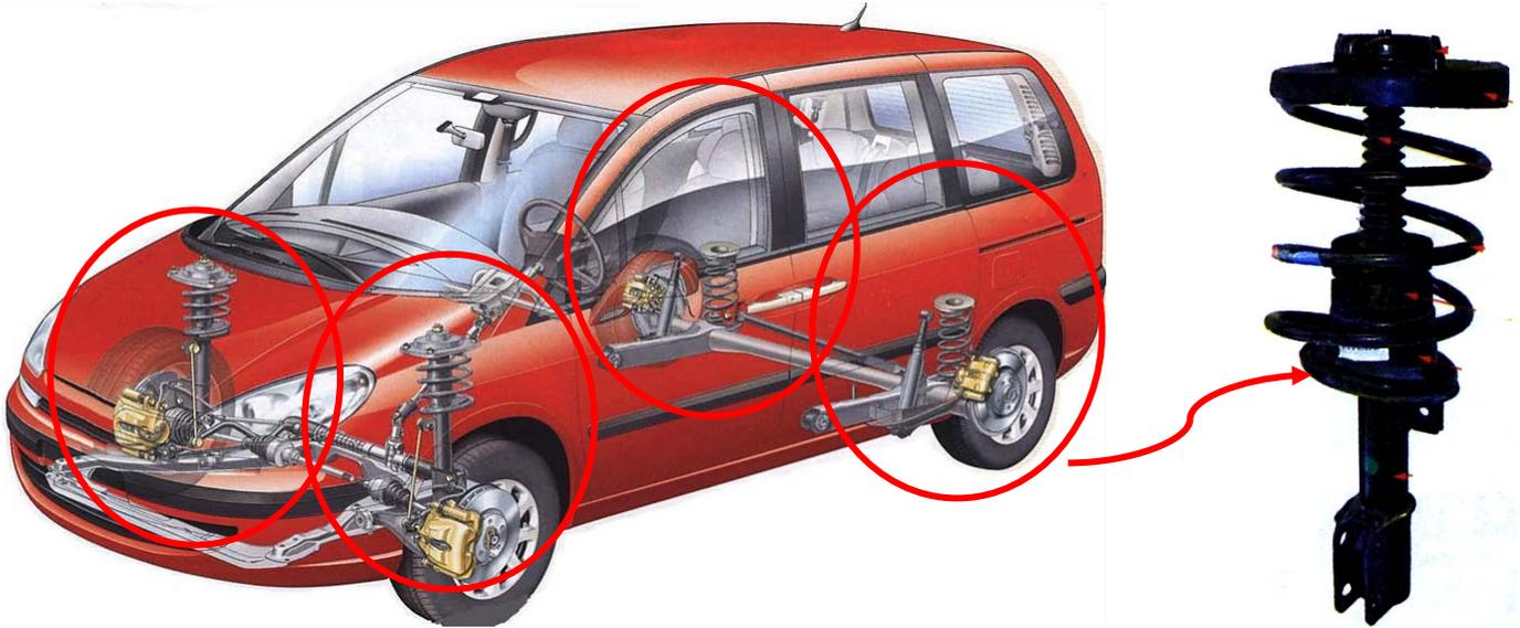
**Destinée à absorber les irrégularités de la chaussée son rôle est double: Elle garantit une bonne tenue de route en maintenant un contact permanent entre les roues et le sol.**
