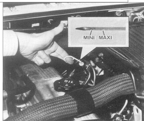
L'huile doit être noire sans traces brunes (présence d'eau dans le circuit de lubrification impliquant des réparations)
