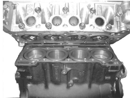
**La culasse assure la fermeture des cylindres dans leur partie supérieure, constituant ainsi la chambre de combustion.**
