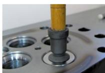
En cas de défauts d'étanchéité, vérifier d'abord l'absence d'écarts de concentricité et de détériorations au niveau des soupapes avant de retoucher les sièges rapportés des soupapes ou de roder les soupapes.
