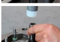
Emmancher les joints de queue de soupape sur les guides à l'aide d'un outil de montage approprié. Les joints de queue de soupape avec supports en plastique peuvent être emmanchés à la main.
