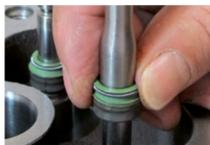
Glisser les joints de queue de soupape sur les tiges de soupape à l'aide d'une douille de protection lubrifiée.
