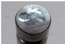
Les queues des soupapes doivent elles aussi être intactes. Par conséquent, rectifier les surfaces des queues de soupape détériorées ou remplacer les soupapes.
