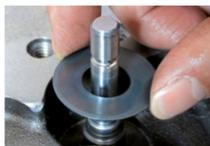
Lubrifier les tiges de soupape avant leur montage définitif et introduire les soupapes dans les guides soupape. Monter les sièges des ressorts de soupape ou les rotateurs de soupape (si prévus).
