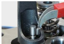
Vérifier la longueur et la perpendicularité des ressorts de soupape. Insérer les ressorts de soupape avec les coupelles des ressorts de soupape et les enfoncer à l'aide d'un outil ou dispositif approprié pour le montage des demi-cônes.
