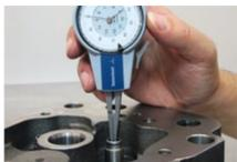
Déduire les cotes de diamètre de la tige de soupape et du guide soupape l'une de l'autre et les comparer aux valeurs de jeu prescrites par le constructeur. Si le jeu est trop important, il se peut que la soupape soit usée ; elle doit dans ce cas être remplacée. Si le jeu est trop faible, retoucher le guide soupape à l'aide d'un alésoir.
