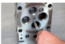
Enlever la cire de conservation des culasses neuves, les laver et vérifier l'absence de détériorations extérieures. Nettoyer les orifices d'huile et les guides soupape à l'aide d'une brosse.
