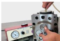
Le contrôle nécessaire de l'étanchéité des soupapes peut être réalisé à l'aide d'un essai de dépression côté canal. En lieu et place de cet essai, il est aussi possible de verser une petite quantité de liquide (essence, pétrole) dans la cavité de la chambre de combustion.
