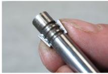
Les zones de serrage et les rainures pour les demi-cônes doivent être intactes et exemptes de bavures. La complémentarité avec les demi-cônes doit elle aussi être parfaite. Pour des raisons de sécurité, les demi-cônes doivent toujours être changés.
