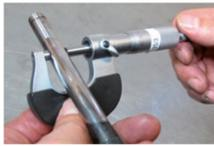
Les tiges de soupape ne doivent présenter aucune trace d'usure visible. Le diamètre des tiges de soupape et la longueur des soupapes doivent correspondre aux instructions du constructeur (manuel d'atelier).
