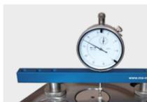
La cote de retrait des soupapes doit correspondre aux instructions du constructeur (manuel d'atelier). Une soupape dont le retrait est trop important doit être remplacée. Si le retrait est trop petit, vérifier qu'il s'agit bien de la bonne soupape. Remplacer la soupape si nécessaire ou retoucher le siège rapporté de soupape jusqu'à atteindre la cote de retrait prescrite.
