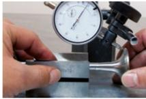
Contrôler la concentricité de la surface du siège de la soupape avec un prisme et un comparateur à cadran. Les soupapes voilées doivent impérativement être remplacées.
