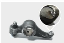
Les zones d'actionnement des soupapes et les coussinets sphériques ne doivent présenter aucune détérioration comme des zones de grippage ou des traces de compression. Pour un jeu axial correct, il faut que les diamètres des axes des culbuteurs et leurs alésages correspondent aux valeurs prescrites par le constructeur du moteur (manuel d'atelier).
