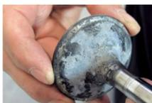
Les sièges des soupapes ne doivent pas présenter de traces de chocs. Sinon : remplacer les soupapes ou retoucher les sièges des soupapes à l'aide d'une rectifieuse de soupapes.
