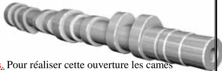
L'arbre à cames sert à l'ouverture des soupapes. Pour réaliser cette ouverture les cames viennent s'appuyer sur les queues de soupapes. Il commande et détermine l'amplitude et la durée du mouvement des soupapes. Il tourne à demi vitesse du vilebrequin.
