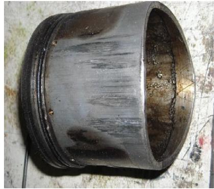
**Figure 2.12. Usure de la partie inférieure de la jupe [12]**
