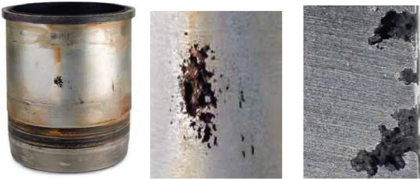
**Figure 2.22. Cavitation sur la chemise [12]**
