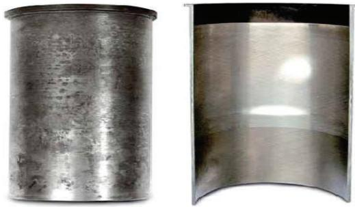
**Figure 2.23. Usure irrégulière du cylindre [12]**
