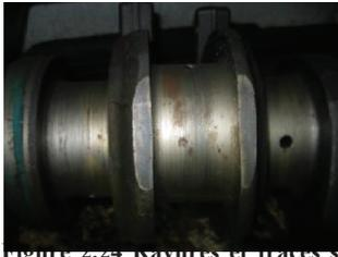
Figure 2.24 Rayures et traces sur le vilebrequin complet du (E.T.U.S.T)
