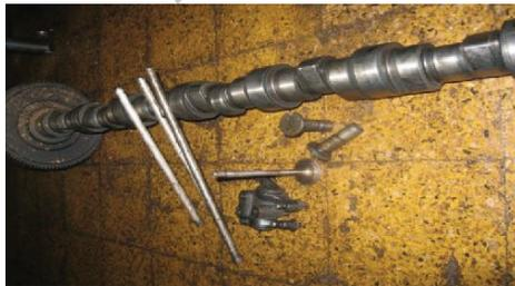
**Figure 1.10.** Soupapes et leurs commandes (E.T.U.S.T)
