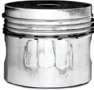
**Figure 2.13 Usure par manque de lubrification sur la jupe [12]**
