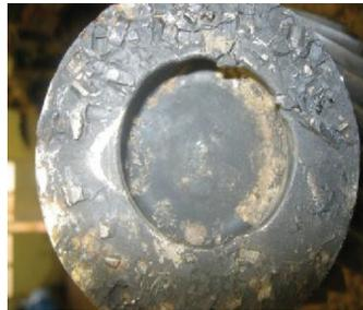
a) Erosion de matière à la segmentation [12] ;      b) Pic d'érosion de la tête du piston (E.T.U.S.T)
