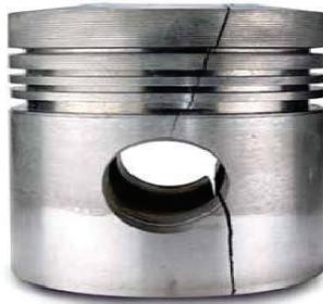
Figure 2.16. Rupture du piston au bossage de l'axe [12]
