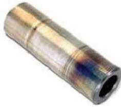
**Figure 2.11 sur échauffement de l'axe [12]**
