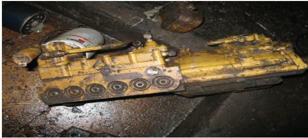
**Figure 1.19. Pompe d'injection (E.T.U.S.T)**
