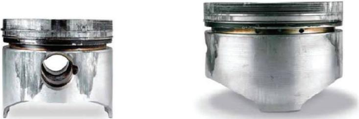
Figure 2.10 Usure aux bossages d'axe par manque de jeu [12]
