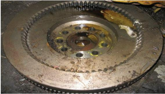
**Figure 1.9.** Volant moteur (E.T.U.S.T)
