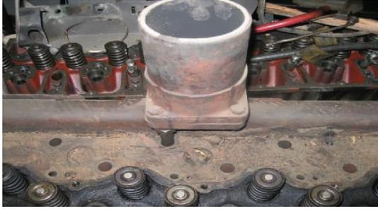
**Figure 1.5.** Collecteurs d'admission et d'échappement (E.T.U.S.T)
