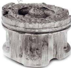
**Figure 2.15. Dilatation et fonte de la tête du piston [12]**
