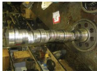
Figure 2.26. Usure de l'arbre à cames (E.T.U.S.T)
