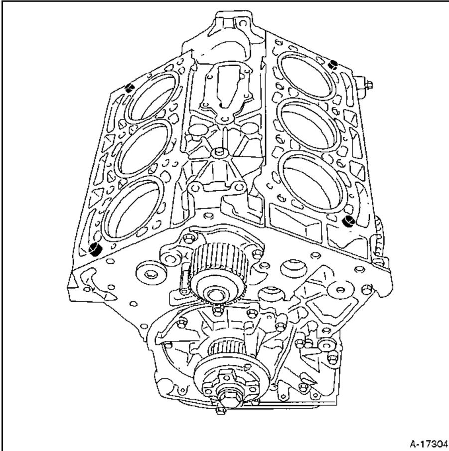
Monter les joints de culasses neufs en s'assurant que les languettes (1) soient tournées vers l'extérieur et vérifier le bon positionnement des trous de montée d'huile (2).
