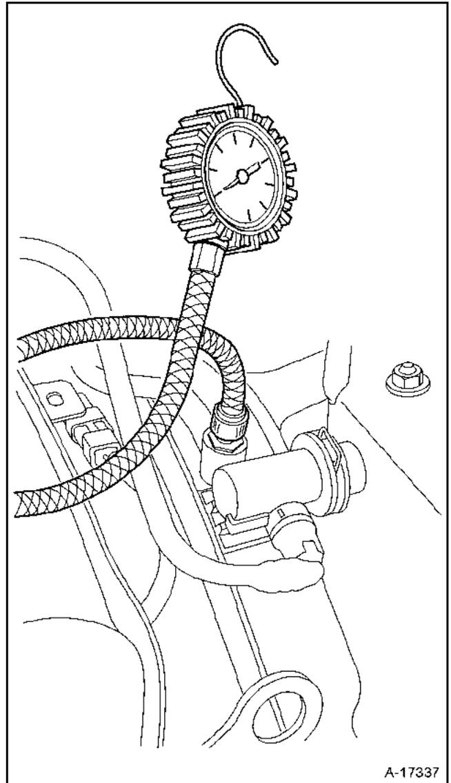
Mettre la clé de contact sur "ON" pour activer la pompe à carburant.
