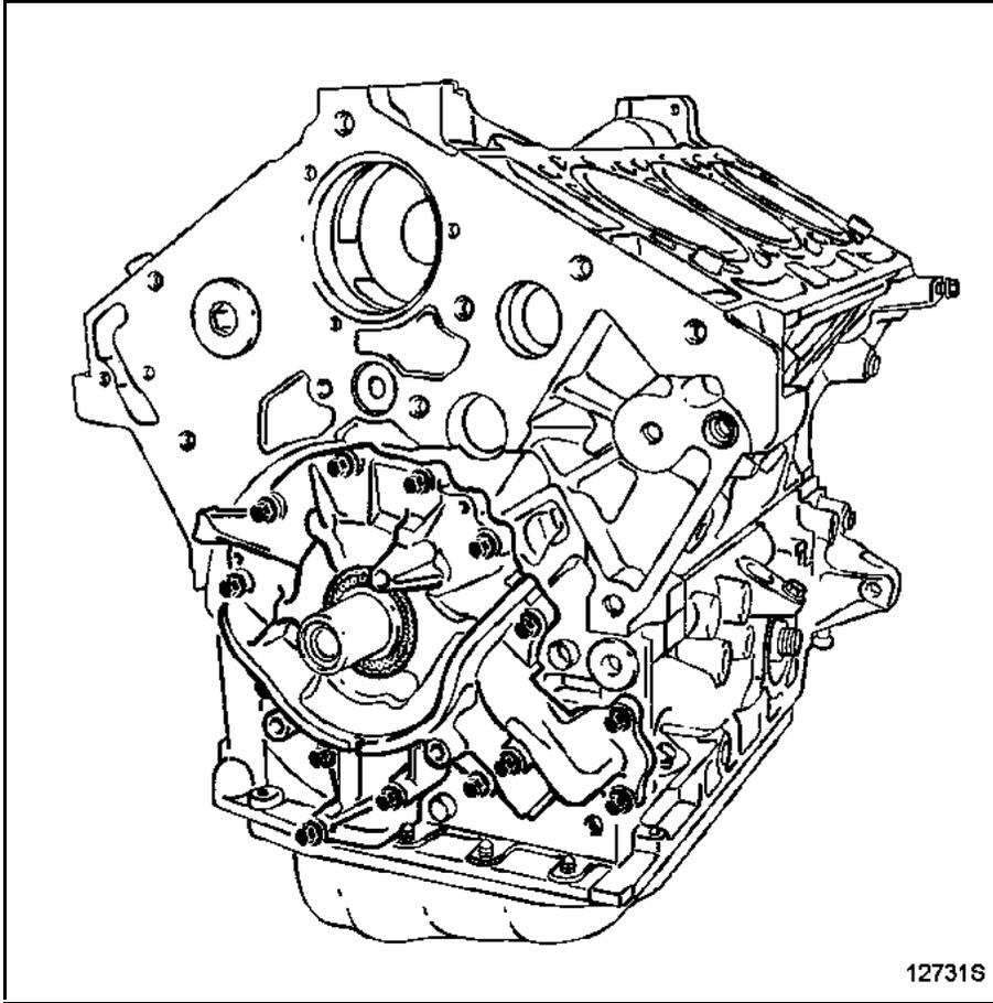
**NOTA :** l'étanchéité de la pompe à huile est assurée par un joint composite supportant plusieurs démontages. Si le joint est blessé, il peut être réparé partiellement avec du produit d'étanchéité **AUTOJOINT OR**.
