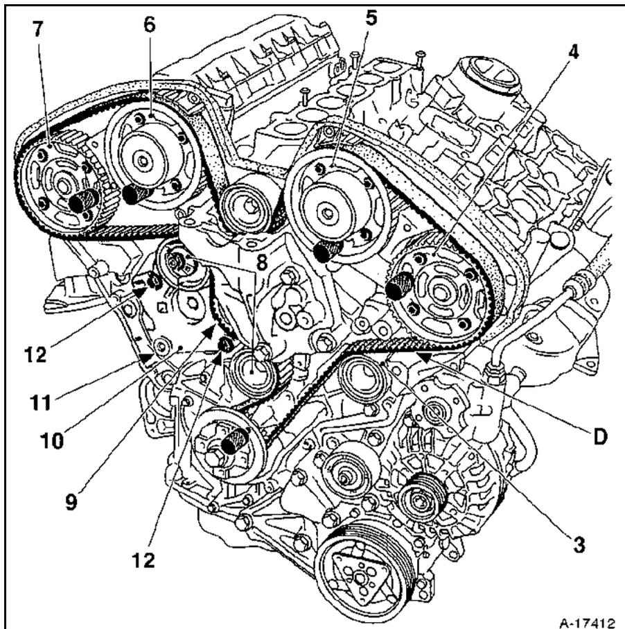
Déposer le **Mot. 1436** et mettre en place le contrôleur de tension, **Mot. 1505** (voir méthode décrite à la **Chapitre 07 - Tension de la courroie de distribution**).
