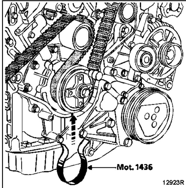
Mettre en place la courroie sur le galet enrouleur (3) en s'assurant que le brin (D) de la courroie soit bien tendu.
