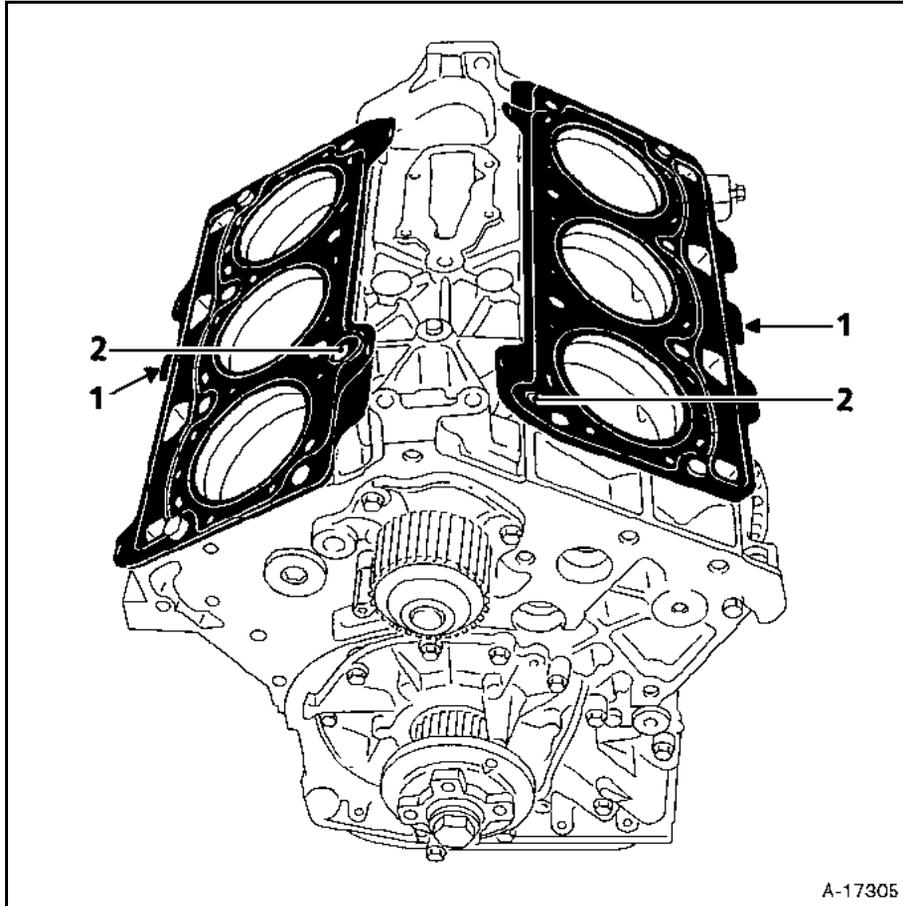
**Contrôler la longueur maximale sous têtes des vis : 149,5 mm.**
