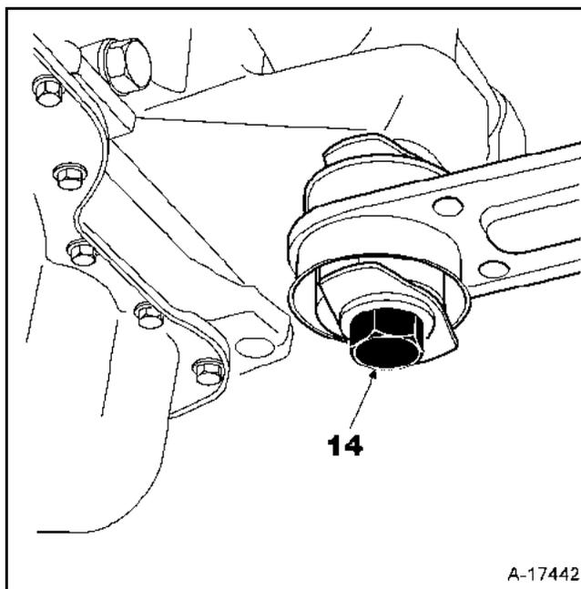
Baisser le véhicule et positionner le **Mot. 1390** sous le berceau, en veillant à avoir accès aux vis de ce dernier.
