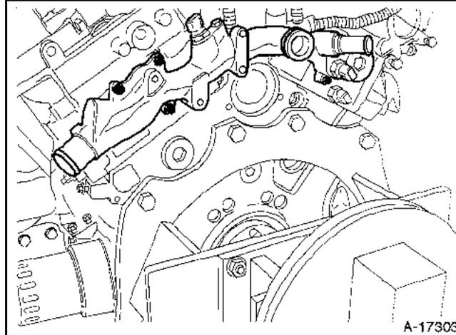
Desserrer progressivement et déposer les vis des carters couvre-arbres à cames suivant la méthode recommandée, puis déposer les carters couvre-arbres à cames.
