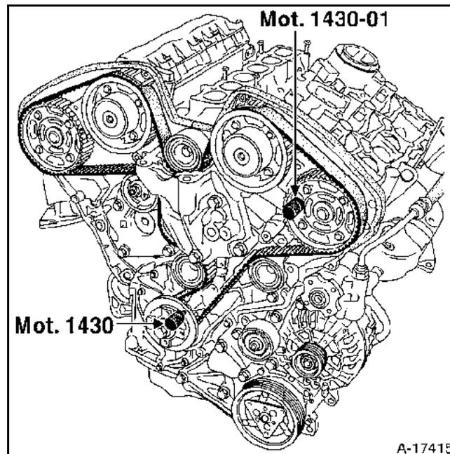
Dans le cas contraire reprendre l'opération de repose de la courroie de distribution.
