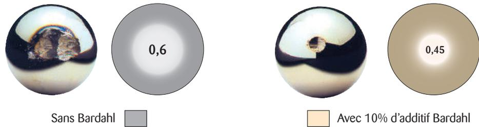
**Test de soudure**
