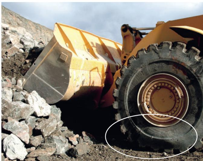
Travail d'un pneu de chargeuse en front de taille
