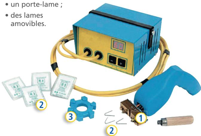
Régler la lame à une profondeur de recreusage qui permette de conserver une épaisseur de gomme suffisante pour protéger les nappes sommet.
