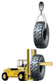
Si soulever et manipuler le pneu par les bourrelets est la seule possibilité, utiliser alors :
