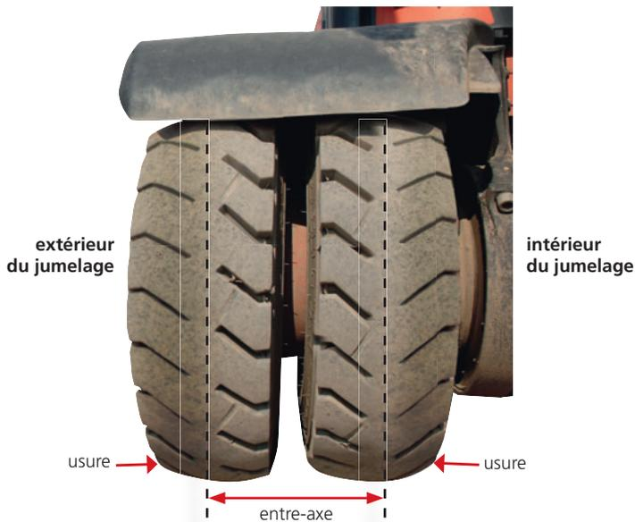
Usure en cône d'un jumelé
