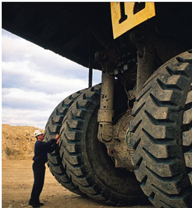
S'assurer qu'il n'y a pas d'objet coincé entre les deux pneus d'un jumelé
