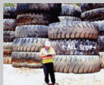
Les pneus en attente d'examen, de réparation, de recreusage, voire de rechapage (ainsi que les pneus en attente de recyclage) doivent être stockés dans des îlots séparés et clairement identifiés.
