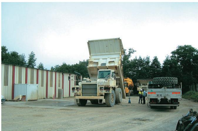
Engins stationnés sur une aire plane, dégagée, stabilisée et propre
