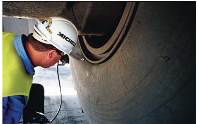
L'examen des pneus sur véhicules nécessite le port de protections individuelles de sécurité
