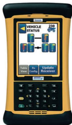
Le MEMS (Michelin Earthmover Management System) est le premier système de surveillance à distance de la pression et de la température des pneus d'engins miniers.
