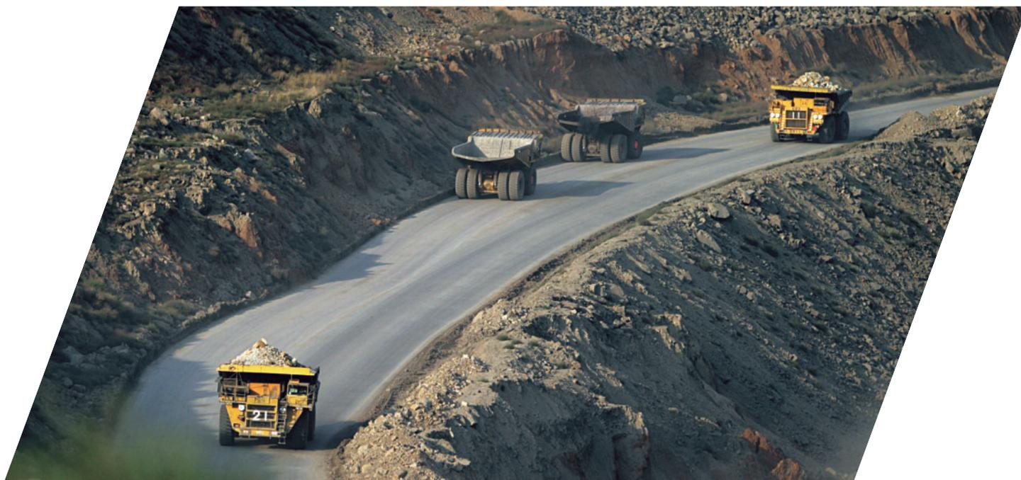
Les cycles longs augmentent les risques de surchauffe (à chargement et vitesse comparables)
