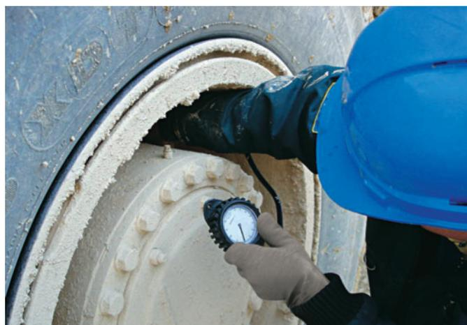
À froid, la pression doit respecter la recommandation à +/- 10 %
