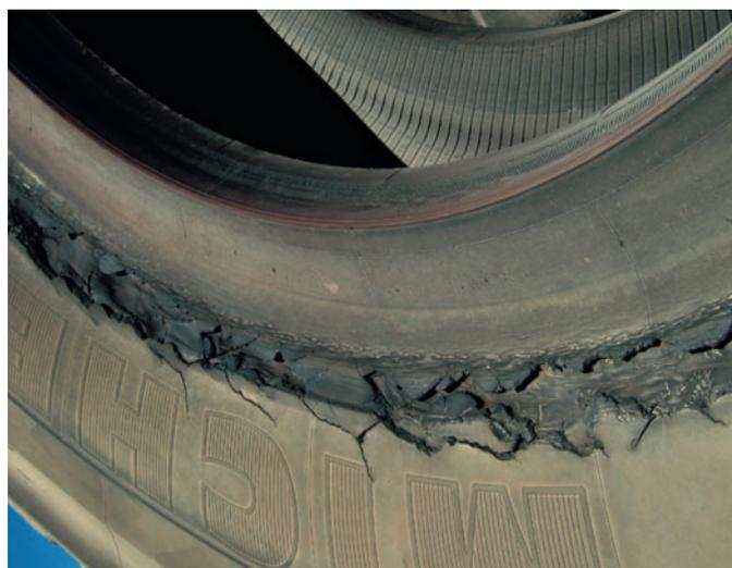
Blessure au bourrelet due à une surcharge du véhicule
