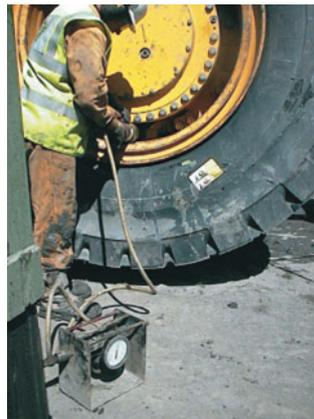
Serrer les écrous en suivant les instructions du constructeur
