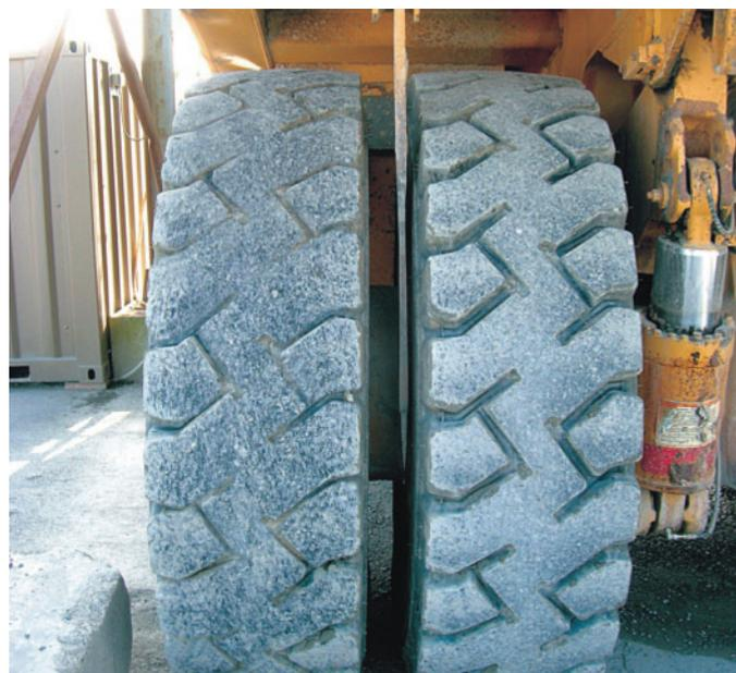
Sur un jumelé, ne pas monter de pneus d'usures différentes
