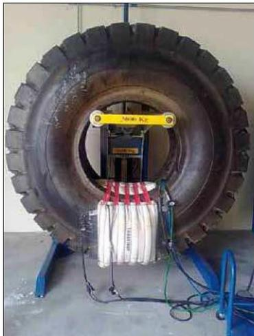
**RTS France SA** propose aux réparateurs des vulcanisateurs ayant pour avantage une souplesse d'utilisation, un faible encombrement et de pouvoir réparer des pneus de toutes dimensions jusqu'au 59/80 R63.
